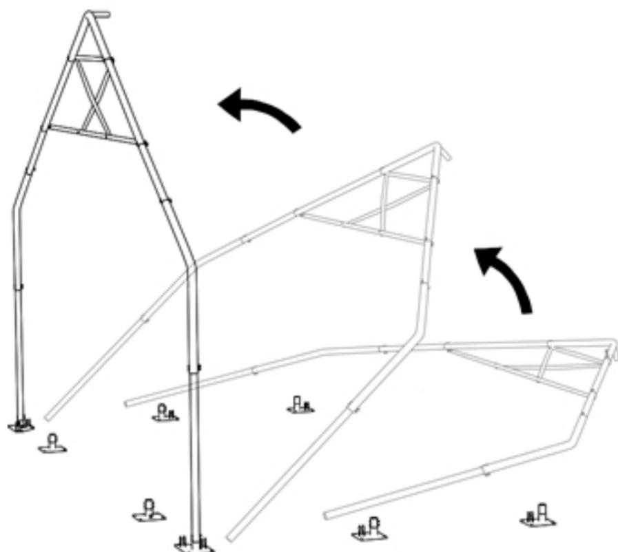
Setzen Sie die einzelnen Rahmen gemäß der Zeichnungen zusammen und fixieren Sie diese nachdem die Füße angelegt wurden. Stellen Sie sicher, dass alle Füße am Boden befestigt sind.
