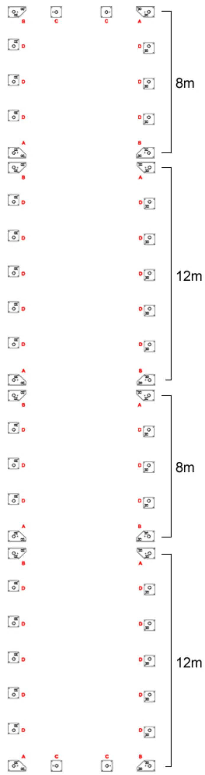
Ordnen Sie die FüÙe auf einer ebenen Fläche in den in der Abbildung angegebenen Abständen an. Für Zelte mit einer Länge von über 12m müssen Sie zuerst separat die Grundkonstruktionen (8x8 oder 8x12) zusammenbauen und dann zusammenbringen, wie auf den Bildern unten gezeigt.
