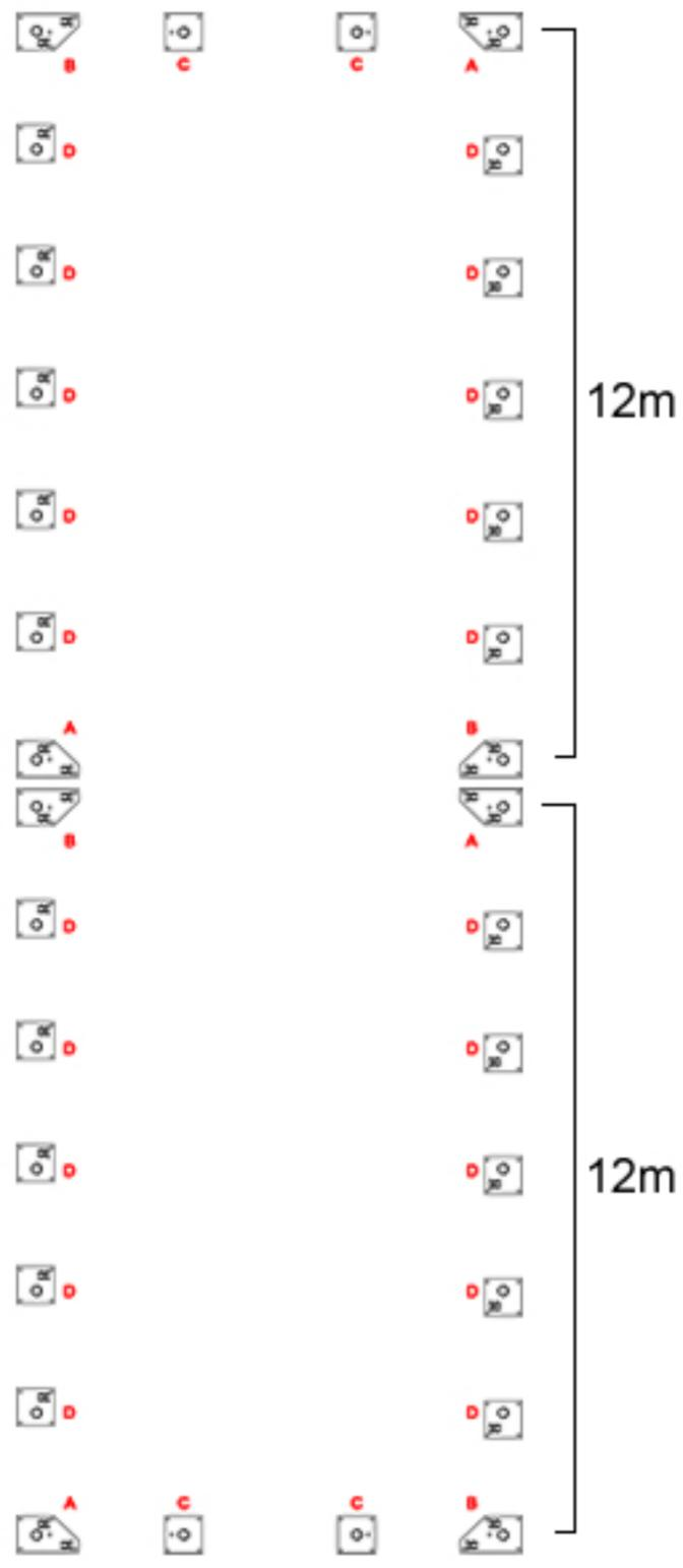
Ordnen Sie die FüÙe auf einer ebenen Fläche in den in der Abbildung angegebenen Abständen an. Für Zelte mit einer Länge von über 12m müssen Sie zuerst separat die Grundkonstruktionen (8x8 oder 8x12) zusammenbauen und dann zusammenbringen, wie auf den Bildern unten gezeigt.
