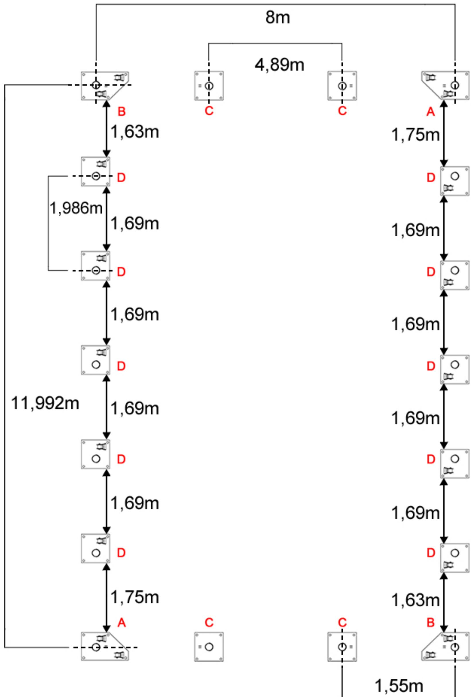
Ordnen Sie die FüÙe auf einer ebenen Fläche in den in der Abbildung angegebenen Abständen an. Für Zelte mit einer Länge von über 12m müssen Sie zuerst separat die Grundkonstruktionen (8x8 oder 8x12) zusammenbauen und dann zusammenbringen, wie auf den Bildern unten gezeigt.
