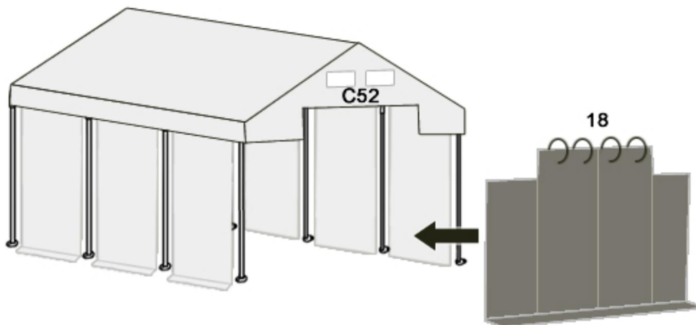
Den oberen Eingangsteil mit Stahlringen (Nr. 18) an dem horizontalen Rohr (Nr. C52) anbringen. Die Eingangsseiten mit Gummischlaufen befestigen.
