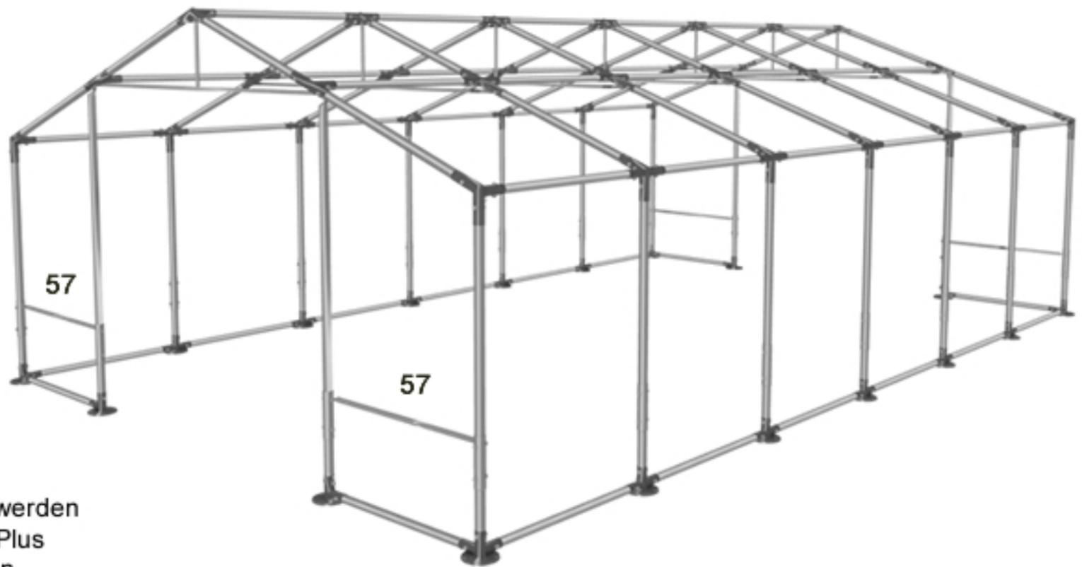
In den Zelten mit der Seitenwandhöhe über 2m werden bei der Konstruktion Polar Plus horizontale Eingangsstützen (Nr. 57) montiert. Die Stützen befestige an der Rohrmuffe des horizontalen Verlängerungsrohr
