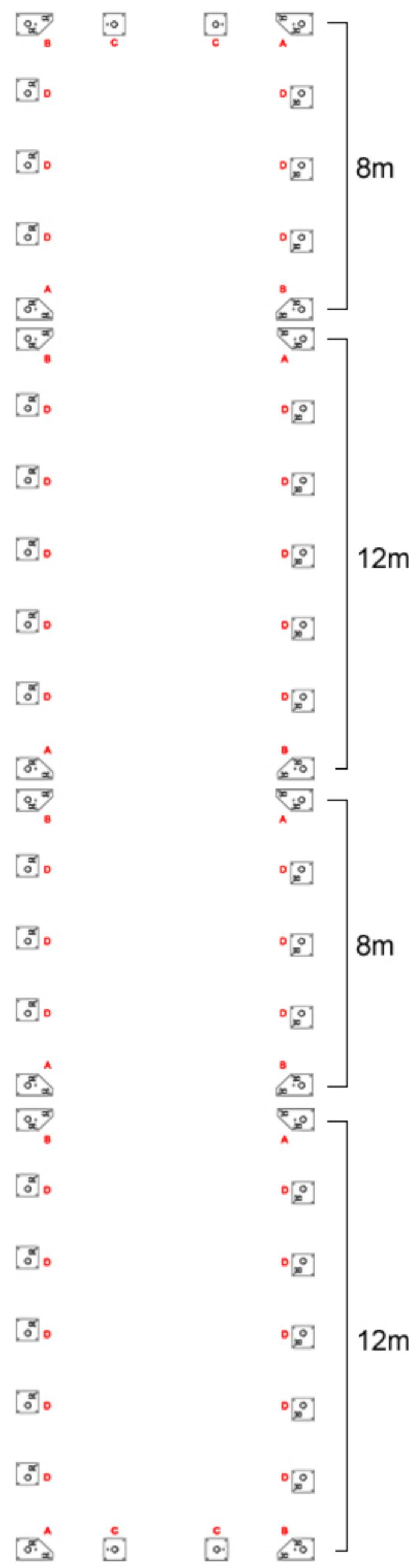
Ordnen Sie die FüÙe auf einer ebenen Fläche in den in der Abbildung angegebenen Abständen an. Für Zelte mit einer Länge von über 12m müssen Sie zuerst separat die Grundkonstruktionen (10x8 oder 10x12) zusammenbauen und dann zusammenbringen, wie auf den Bildern unten gezeigt.
