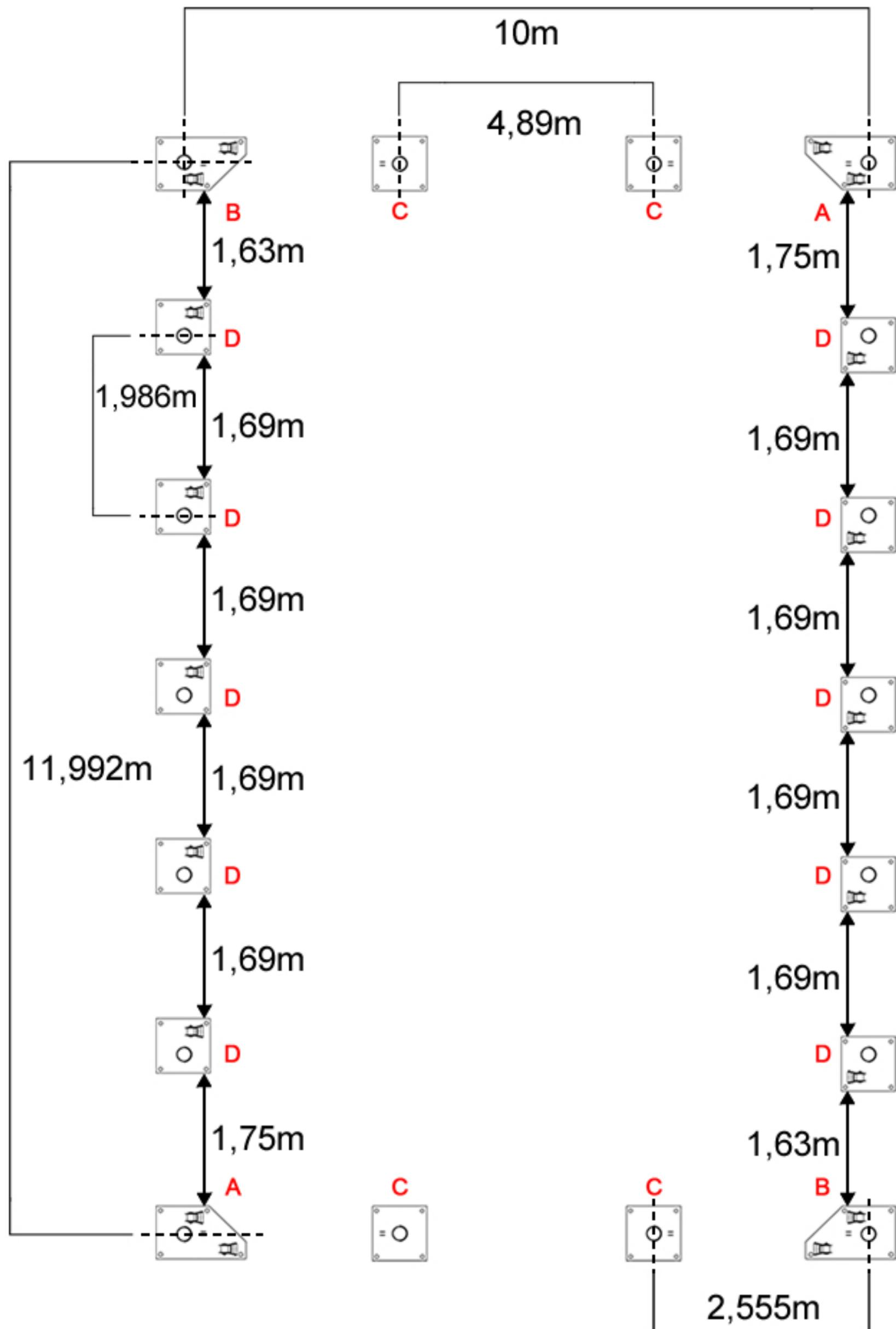
Ordnen Sie die FüÙe auf einer ebenen Fläche in den in der Abbildung angegebenen Abständen an. Für Zelte mit einer Länge von über 12m müssen Sie zuerst separat die Grundkonstruktionen (10x8 oder 10x12) zusammenbauen und dann zusammenbringen, wie auf den Bildern unten gezeigt.
