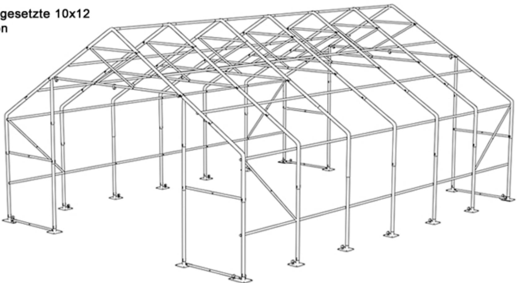
**Zusammengesetzte 10x12 Konstruktion (eine Kombination aus zwei
