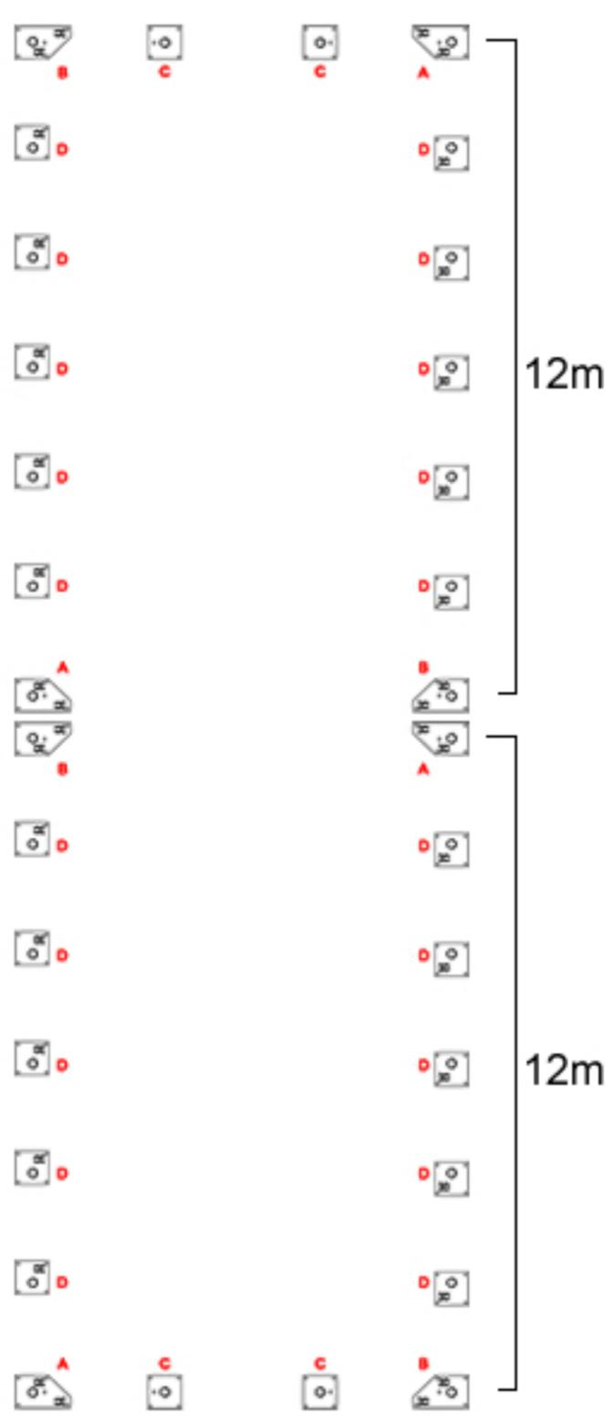
Ordnen Sie die FüÙe auf einer ebenen Fläche in den in der Abbildung angegebenen Abständen an. Für Zelte mit einer Länge von über 12m müssen Sie zuerst separat die Grundkonstruktionen (10x8 oder 10x12) zusammenbauen und dann zusammenbringen, wie auf den Bildern unten gezeigt.
