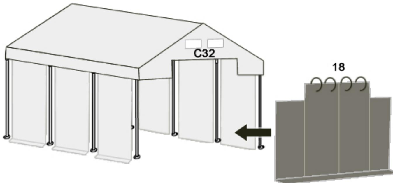
Den oberen Eingangsteil mit Stahlringen (Nr. 18) an dem horizontalen Rohr (Nr. C32) anbringen. Die Eingangsseiten mit Gummischlaufen befestigen.
