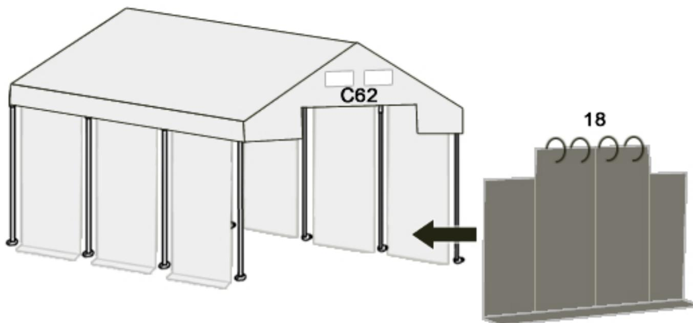
Den oberen Eingangsteil mit Stahlringen (Nr. 18) an dem horizontalen Rohr (Nr. C62) anbringen. Die Eingangsseiten mit Gummischlaufen befestigen.
