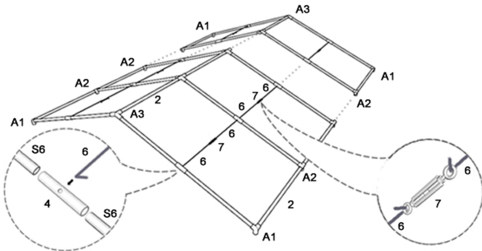
Die verbundenen Elemente sollten wie auf dem Bild aussehen. Man soll die Seile mit den Haken an die Verbinder anhängen. Befestige die Seile an den römischen Schrauben. Die Seile mit den Haken sollten über der Konstruktion montiert werden. Vergiss nicht, die Haken nach unten zu richten. Sonst kann die Plane beschädigt werden.
