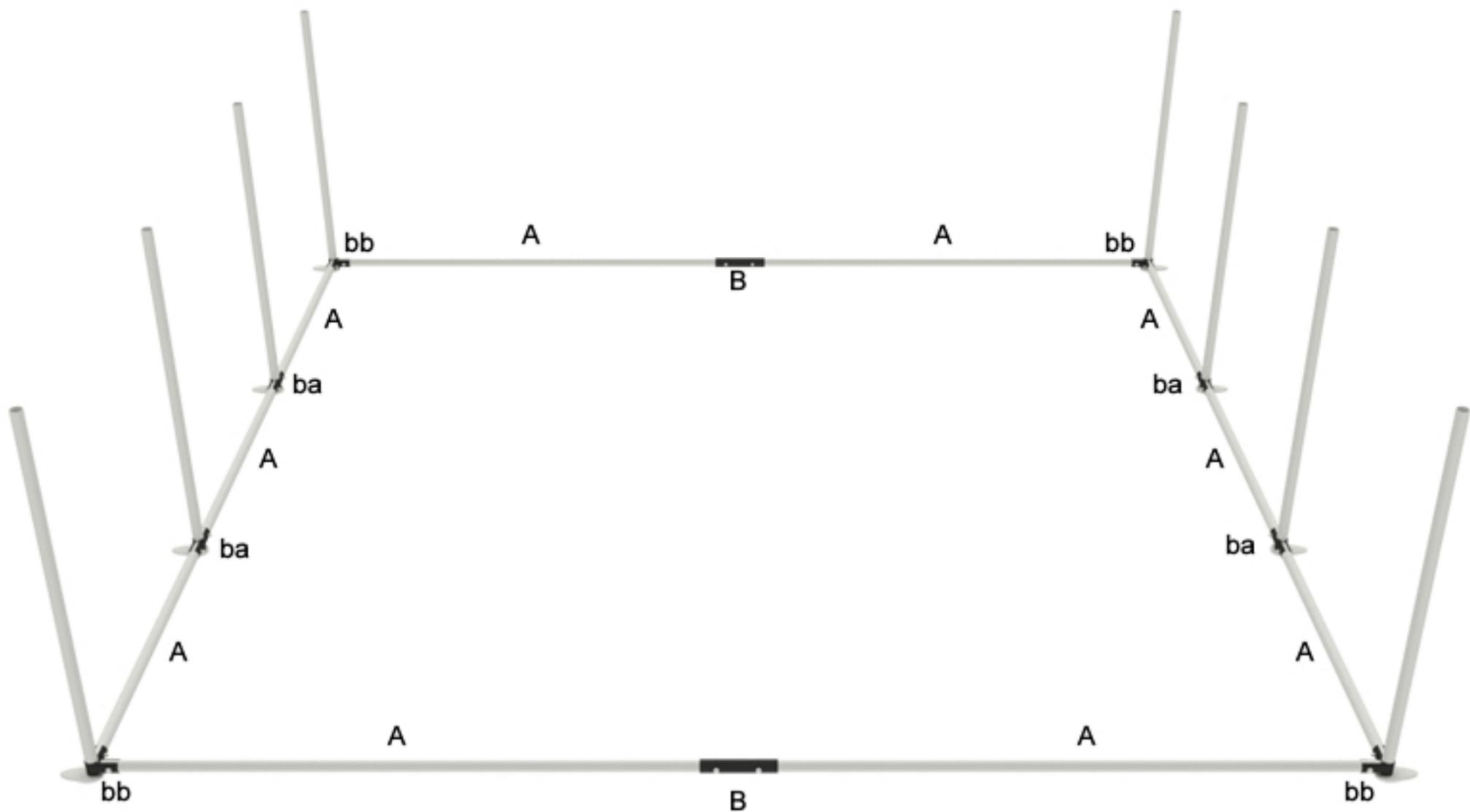
Die Bodenkonstruktion soll man mit Hilfe von den Schrauben S. wie unten auf dem Bild montieren.
